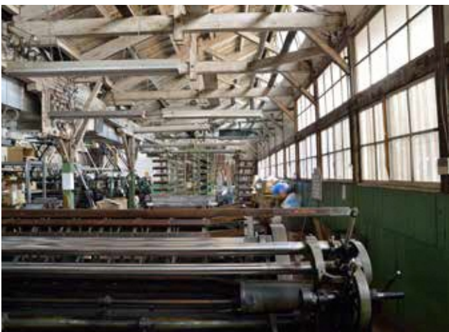
トラス組の屋根が見える①工場内部。今も低速の「ジョンヘル型織機」11基で高級紳士服の生地を織っている。
